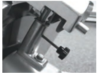
3. Die Schleifvorrichtung der Maschine sichern, indem Sie den Haltering anziehen. Vor der Inbetriebnahme der Maschine die Festigkeit der Schleifvorrichtung prüfen.
