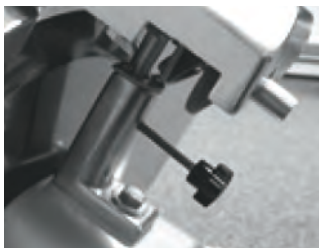
3. Fixați dispozitivul de ascuțire la aparat prin strângerea suportului. Verificați pentru a vă asigura că dispozitivul de ascuțire este bine securizat înainte de a utiliza aparatul.
