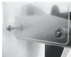
3. Așezați ambele garnituri peste șuruburi.
